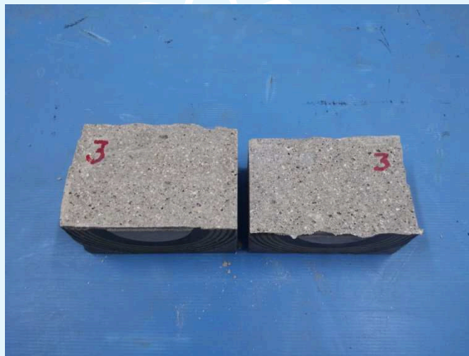
Fotografie dei provini n. 2 e n. 3 sezionati al termine della prova.
